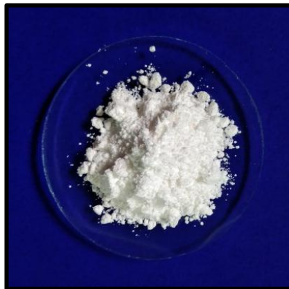
Figure .3.3.1 (d) Cd-BDC Metal Organic Frame work (Powder form)
