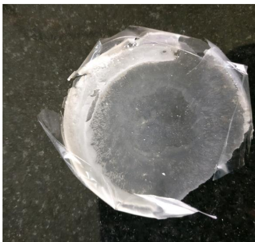
Fig 22. Film of Pectin/Guar gum/ \text{MgSO}_4 \cdot 7\text{H}_2\text{O} /EC
